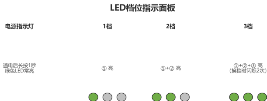
图 5：LED 档位指示面板
